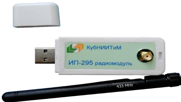
Модуль ИП-295 предназначен для подключения управляющего компьютера к беспроводной сети 433 МГц для установления связи с беспроводными первичными преобразователями и, через модуль ИП-294, с различными модулями сбора данных измерительной системы ИП-264.
