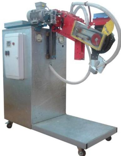
Стенд ИУ-95 предназначен для ускоренных стендовых испытаний высевяющих аппаратов сеялок точного высева.
