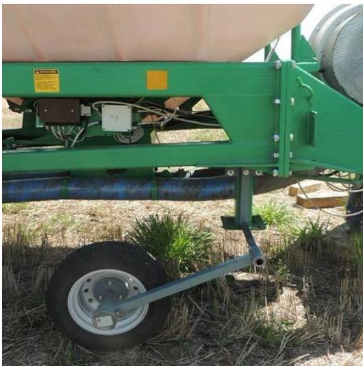
Измеритель ИП-266 предназначен для определения пройденного пути, скорости движения агрегата, буксования и производительности при испытаниях с/х техники в соответствии с действующими межгосударственными стандартами на методы испытаний. Конструкция измерителя пройденного пути ИП-266 позволяет оперативно монтировать его на любой тип машин.
