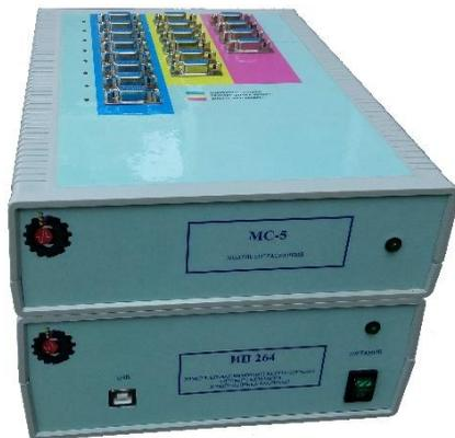
Измерительная информационная система (ИИС) предназначена для научно-исследовательских, и испытательских целей, а также энергетической, эксплуатационно-технологической оценок машин и тяговых испытаний тракторов. Обеспечивает прием дискретных и аналоговых сигналов от первичных преобразователей любого типа.
