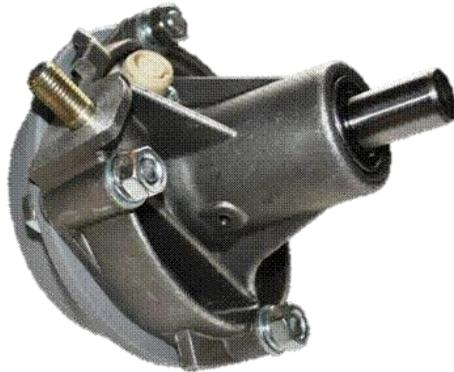
Предназначен для измерения частоты вращения ведущих колес тракторов и сельскохозяйственных машин.
