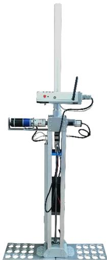
Электронный измеритель твердости почвы ИП-271 предназначен для измерения твердости почвы при погружении плунжера на глубину до 400 мм.
