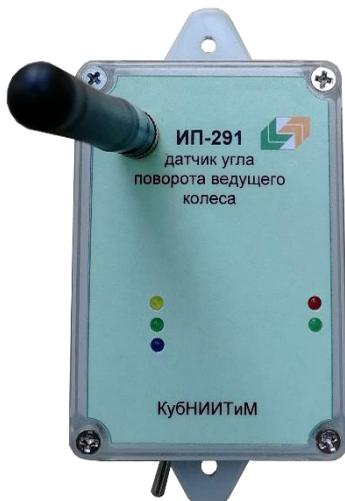
Датчик ИП-291 предназначен для определения угла поворота ведущего колеса агрегата. Это позволяет определить буксование ведущих колёс тракторов сельскохозяйственного назначения при проведении различных видов испытаний.
