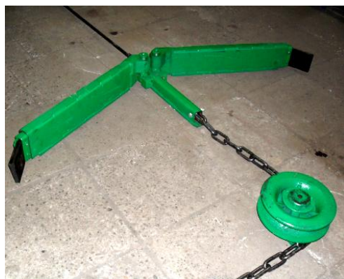
Рис. 32 – Общий вид рабочего органа с частью цепного контура и поворотного устройства установки УНС-1
