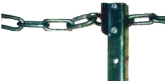
Рис. 26 – Общий вид элемента цепи со скребком транспортера ТСН-160А
