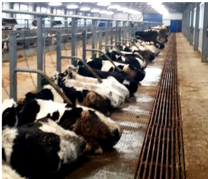
Рис. 39 – Транспортёр ТШГ-190, установленный на ферме
